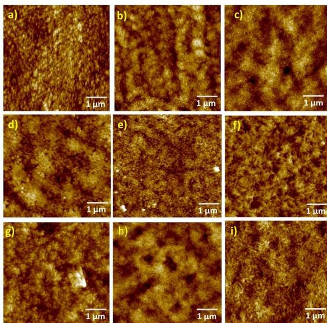
**Fig. 3.** AFM images of thin films deposited on FTO substrates: a) FeOOH-50 mC, b) FeOOH-100 mC, c) FeOOH-250 mC, d)  $Fe_2O_3$ -50 mC, e)  $Fe_2O_3$ -100 mC, f)  $Fe_2O_3$ -250 mC, g)  $ZnFe_2O_4$ -50 mC, h)  $ZnFe_2O_4$ -100 mC i)  $ZnFe_2O_4$ -250 mC.
