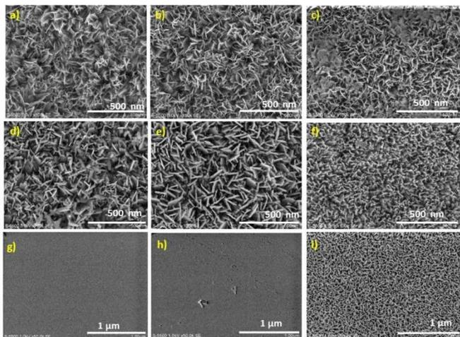
**Fig. 2.** : FE-SEM images of thin films deposited on FTO substrates: a) FeOOH-50 mC, b) FeOOH-100 mC, c) FeOOH-250 mC, d)  $Fe_2O_3$ -50 mC, e)  $Fe_2O_3$ -100 mC, f)  $Fe_2O_3$ -250 mC, g)  $ZnFe_2O_4$ -50 mC, h)  $ZnFe_2O_4$ -100 mC i)  $ZnFe_2O_4$ -250 mC.
