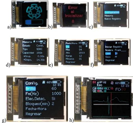
Fig. 2. Display screens. a) Start. b) Error. c) Main. d) Memory. e) Date-Time. f) Patient data. g) Configuration. h) Record.
