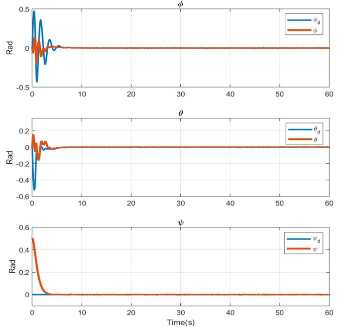
Fig. 3. Quadrotor orientation
